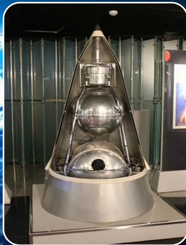
Герметичная кабина выглядела как цилиндр с выпуклым дном. В кабине имелись автомат питания, система кондиционирования, которая представляла собой регенерационную установку.
