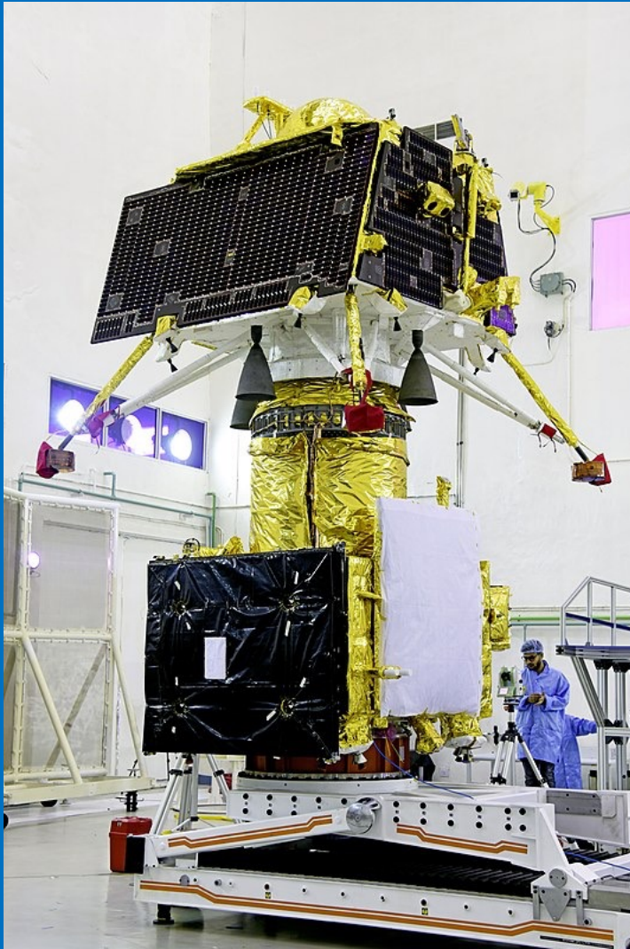
Орбитальный и посадочный модули «Чандраян-2». Ровер находится внутри посадочного аппарата
